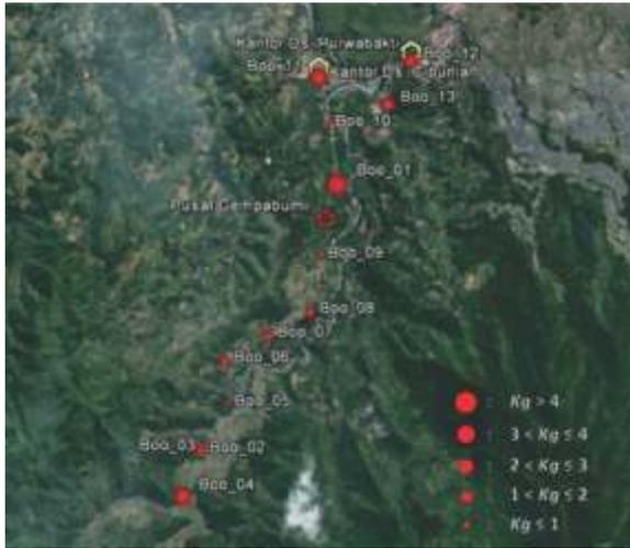
**Gambar 7. Distribusi nilai indeks kerentanan seismik ( $K_g$ ) di 13 titik pengukuran**
