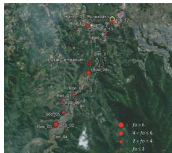
**Gambar 4. Distribusi nilai frekuensi dominan (*f<sub>o</sub>*) di 13 titik pengukuran**
