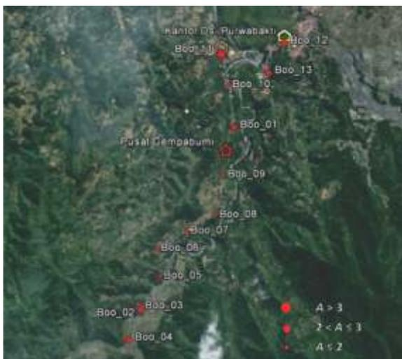
Gambar 5. Distribusi nilai faktor amplifikasi ( $A$ ) di 13 titik pengukuran
