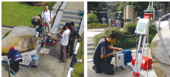
Gambar 11. Kegiatan pengukuran di lapangan dalam rangka validasi perangkat lunak koreksi pasang surut gaya berat di titik pangkal gaya berat DG1A (halaman Museum Geologi). Validasi yang dilakukan meliputi 2 hal yaitu validasi fasa dan validasi amplitudo berdasarkan Gravity Tide Observed, Instrument Based Test , dan Software Based Test .
